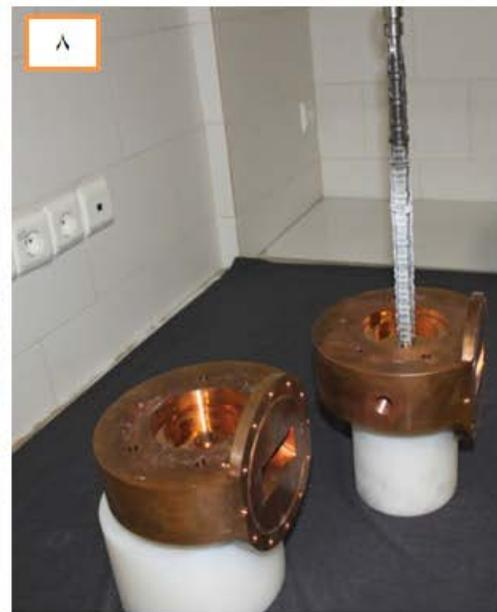
مراحل مونتاژ قسمت‌های تیوب شتابدهی به روش انقباضی؛ ۱- بستن دیسک‌ها بر روی فیکسچر و جدا کردن آن‌ها از پایه صفحه‌ها برای مونتاژ تیوب دوم، ۲- هم‌ترازی فیکسچر و تیوب دوم، ۳- جازدن صفحه‌ها در تیوب دوم، ۴- تصویری از داخل تیوب بعد از جدا کردن فیکسچر (صفحه‌ها بخوبی مشخص‌اند)، ۵- پایه نگه‌دارنده صفحه‌های بانچر (صفحات بانچر قطرها و فاصله‌های متفاوت از یکدیگر دارند)، ۶- بانچر پس از جازدن صفحه‌ها، ۷- فیکسچر تک‌صفحه‌ای برای جازدن صفحه کوپلرها، ۸- جازدن صفحات در کوپلرها
