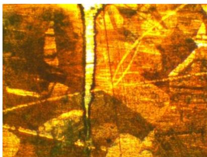
Рис.7. Микроструктура зоны пайки (медь+ПСр 72+ медь)х200
