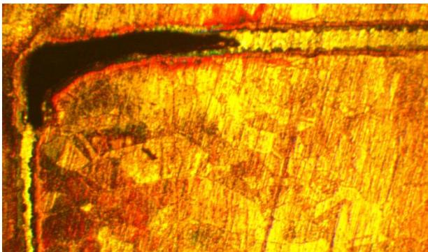
Рис.1. Микроструктура зоны пайки (медь+ПСр 72+ медь) x 50
