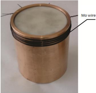
Նկ. 7. ԳլանակաՆ կերամիկայի դիսկի և պղնձե խողովակի միացումը:
