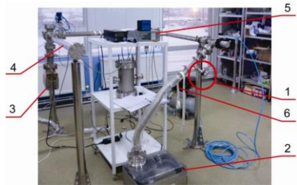
Նկ. 8. ա. Կերամիկա-մետաղ միացության մեխանիկական հատկությունների փոփոխությունը՝ ջերմաստիճանից կախված, բ. կերամիկա-մետաղ միացության ջերմային փորձարկումը:
